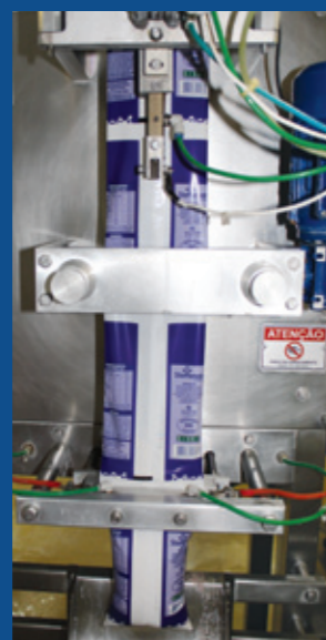
Processo de envase de bebida láctea em sacos plásticos (“barriga mole”).
