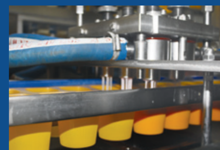
Processo de envase de bebida láctea em bandejas de 540 g.
