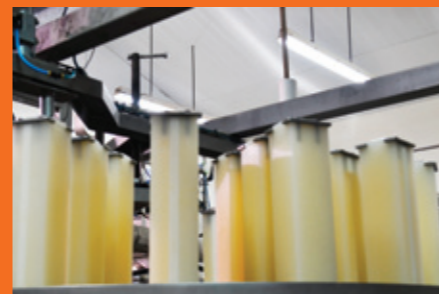
Processo de moldagem da massa do queijo.
