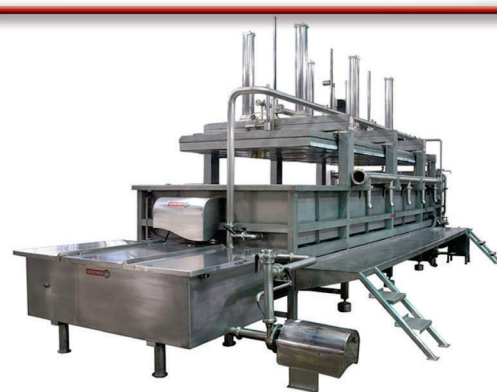
Tanque de Pré-Prensagem
