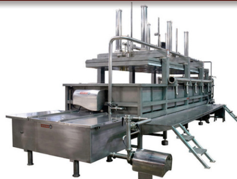
Tanque de Pré-Prensagem
